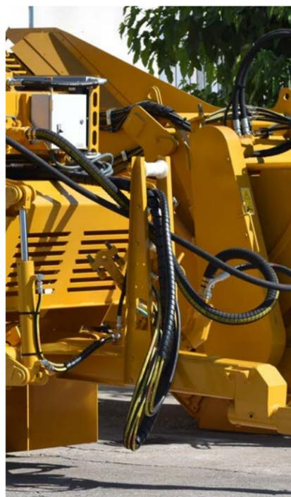
Todas las tomas para acoplar los latiguillos para el accionamiento de los cilindros hidráulicos son de tipo enchufe rápido macho 1/2" certificado, cumpliendo funcionalmente los valores establecidos en cuanto a presiones y caudales.
