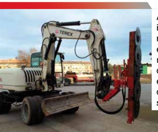
Al igual que la cuchara, martillo hidráulico u otro implemento acoplado a una retro-excavadora, nuestras prepodadoras pueden ser instaladas en estos brazos articulados, de manera sencilla y rápida. Tan sólo es preciso conectar los flexibles que van dotados de enchufes rápidos y alimentar el motor hidráulico de giro, a una de las utilidades de servicio de la máquina, y que actuaremos con su mando correspondiente.
