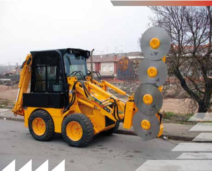
Las máquinas prepodadoras se pueden montar en los brazos de la pala cargadora, ya sean de enganche rápido ó por bulones. Es preferible que el brazo de pala superior sea corto.
